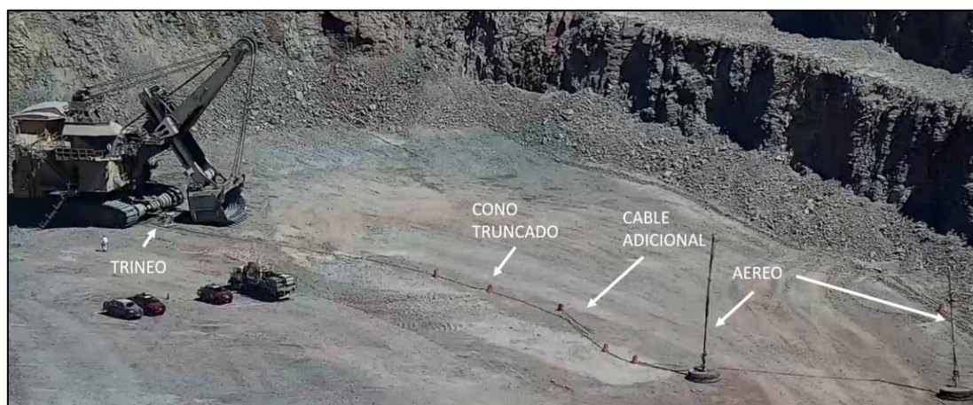
Figura 4. Posición de cable y aéreos.
