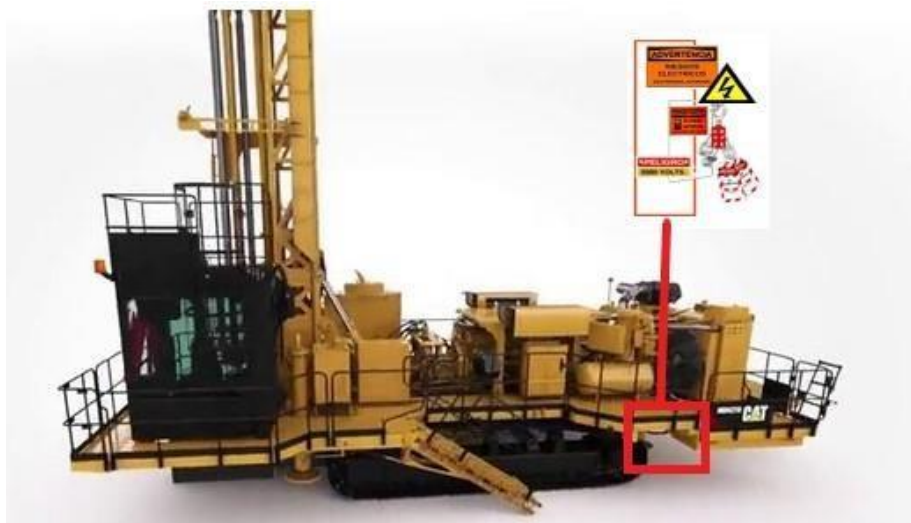
Ubicación de Bloqueo en Perforadoras MD6540 CAT (Equipos N°9 y 10)
