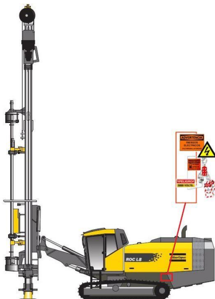
Ubicación de bloqueo Perforadoras de Precorte Epiroc (Equipos N°8 y N°11)
