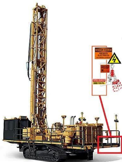
Ubicación de Bloqueo en Perforadoras MD6420 CAT (Equipos N°6 y N°7)
