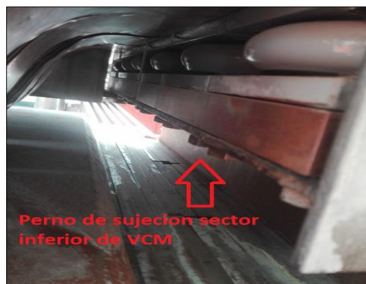
Imagen N° 8.2 muestra pernos de sujeción inferior
