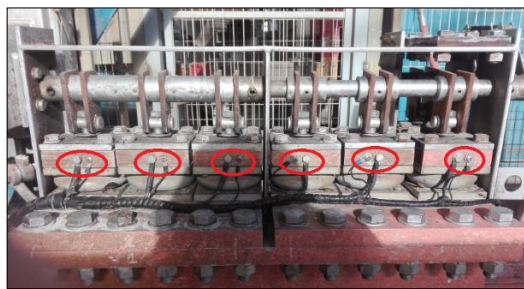
Imagen 6.1 muestra pernos a retirar en Switch.
