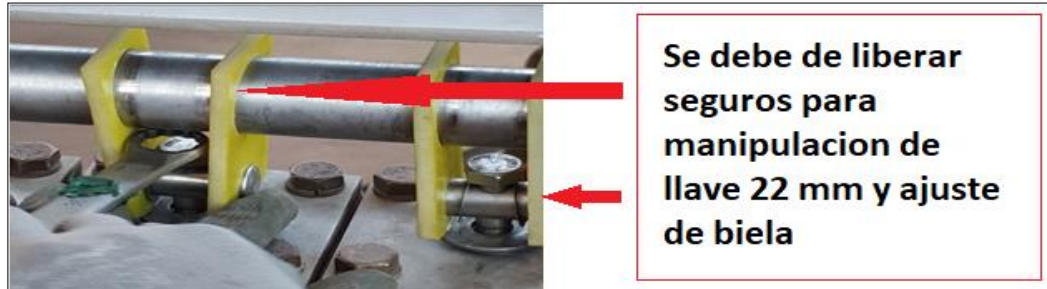
Imagen 6.1 Muestra cómo debe de realizar ajuste en Biela.
