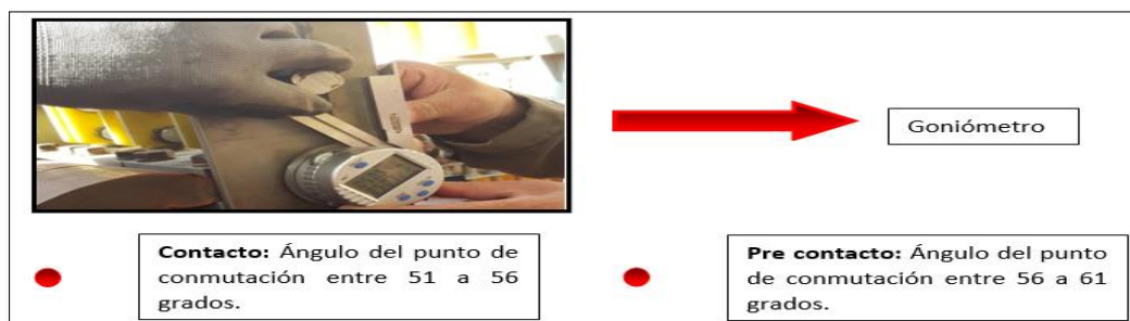
Imagen 7.1 Muestra cómo se debe dar inclinación de inicial.
