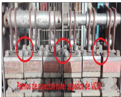
Imagen N° 8.1 muestra pernos a soltar en VCM.
