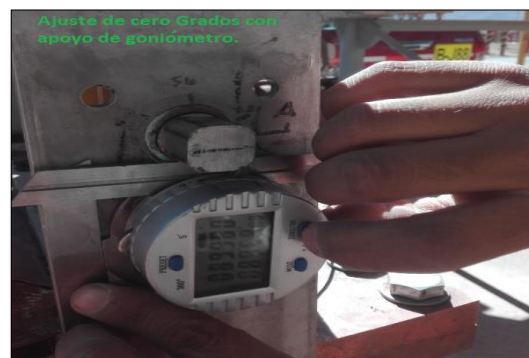
Imagen 5.2 Muestra Goniómetro para ajuste
