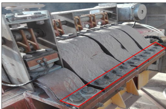
Imagen 3.1 muestra retiro de pernos de sujeción de Switch 1 y 2.
