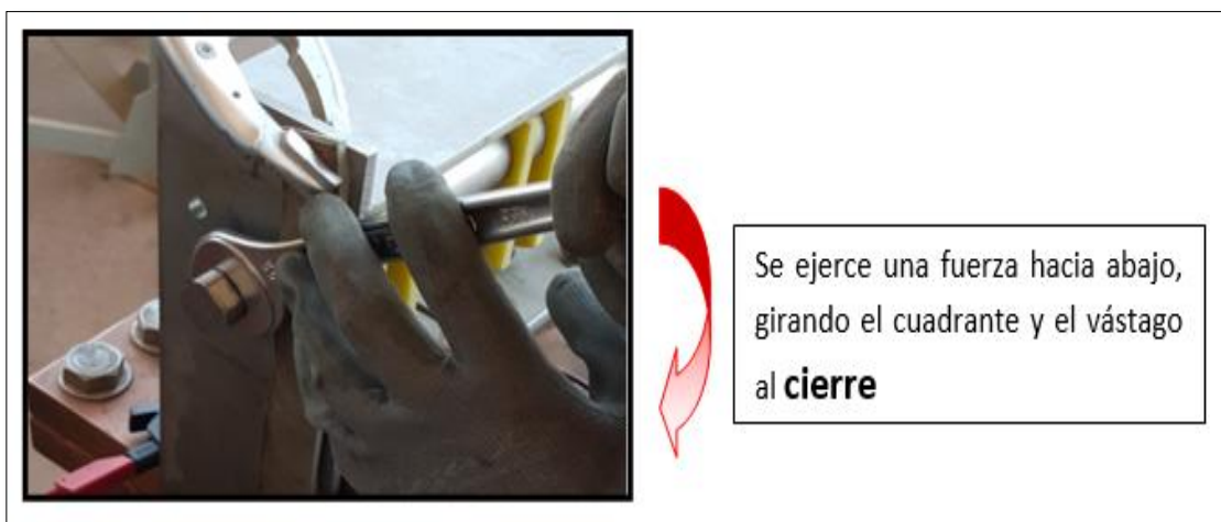
Imagen 4.1 muestra posición inicial de vástago.
