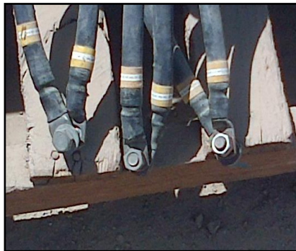
Fig.5.2 Bobinas seleccionadas según prueba de continuidad.
