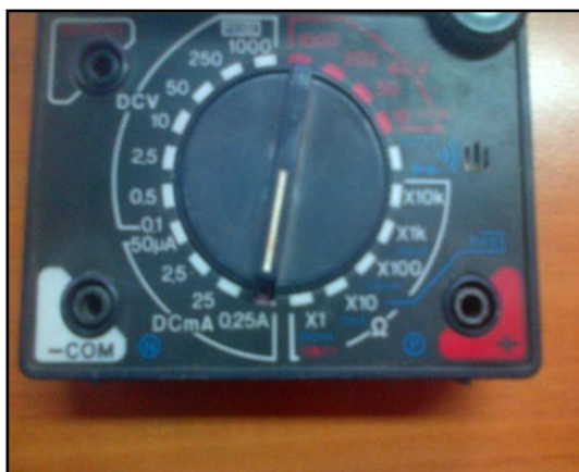
Fig.5.3 Multitester análogo con la escala más baja.
