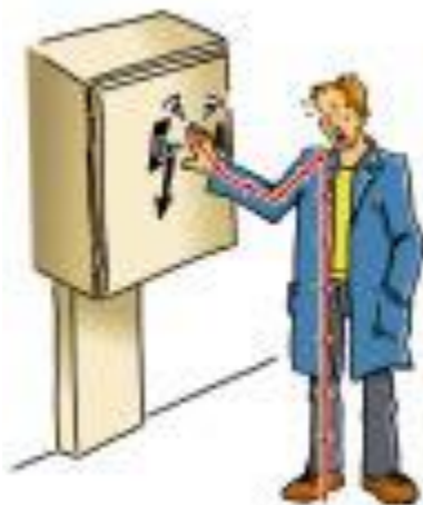
Fig.5.10. Contacto Indirecto con Carcasa de Tablero Energizado.
