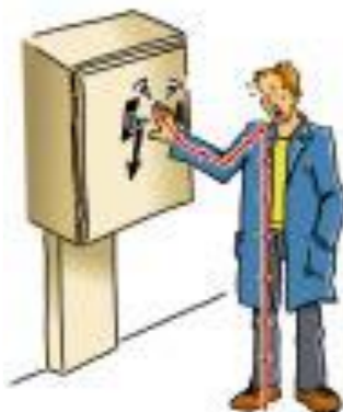
Fig.5.10. Contacto Indirecto con Carcasa de Tablero Energizado.
