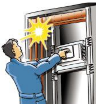
Fig.5.11. Arco Eléctrico por Maniobra.
