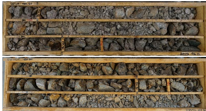
Figura 20: Ejemplos de cajas de sondaje con testigos muy fracturados, requiriendo un muestreo sin corte con sierra
