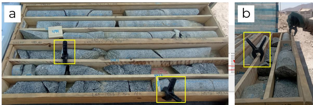
Figura 8: (a) Posición pinzas vista en planta marcando dos metros (b) Posición pinzas vista de perfil y su forma de instalar.
