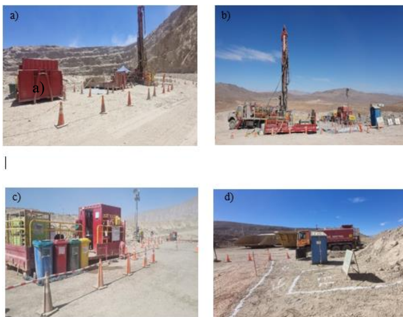
Figura 3: Condiciones básicas que deben cumplir las plataformas de sondaje de acuerdo con las normas de seguridad de la ESE de perforación y CMLB. a) Distribución de equipos de perforación y servicios básicos. b y c) Distribución de materiales en sector de controlador ESE CMLB. d) Ubicación de caseta de ESE de perforación alejada de línea de fuego. e) Contenedores para segregación de residuos. f) Demarcación de PEE.
