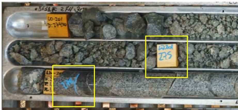
Figura 15: Marcas de regularizado en taco y en testigo de roca.
