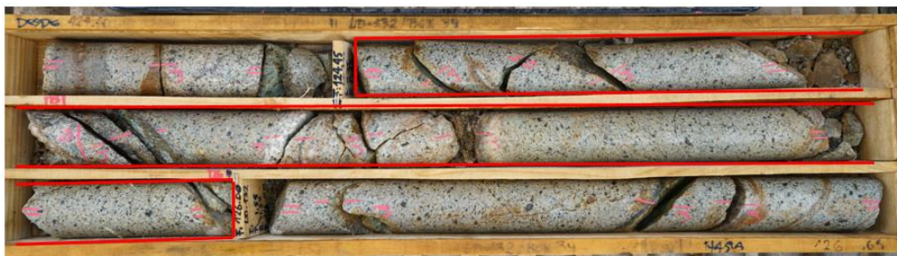
Figura 10: Tacos de perforación ubicados en una sola caja
