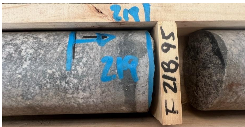
Figura 20. Indicación con marca de flecha donde se debería ubicar el taco de perforación.
