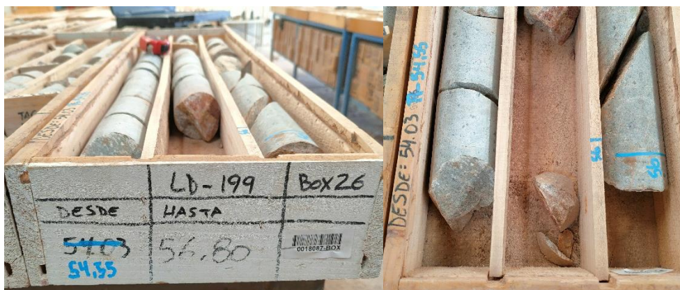
Figura 21. Se observa cambio de metraje en frontis y final de caja.
