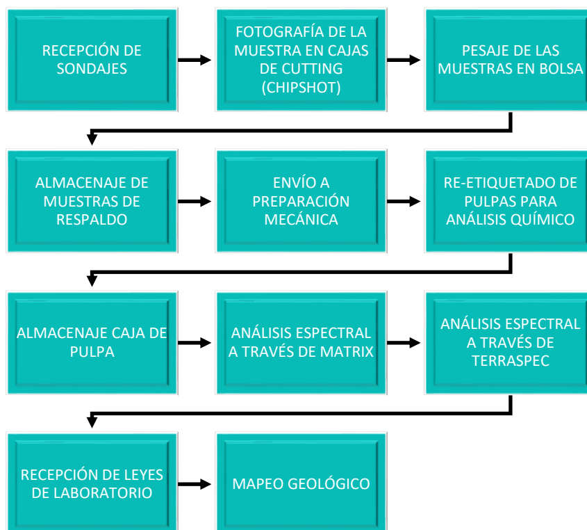
Imagen 25: flujograma de procesos de mostrera hasta mapeo geológico para sondajes de aire reverso.
