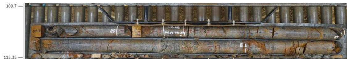
Figura 36. Error en el uso de Cropping y falta de revisión de fotografía.
