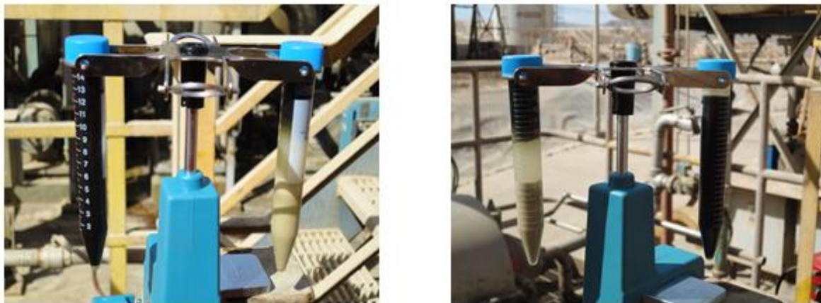
Fig. N°9: Centrífuga muestra alimentación y descarga Tricanter
