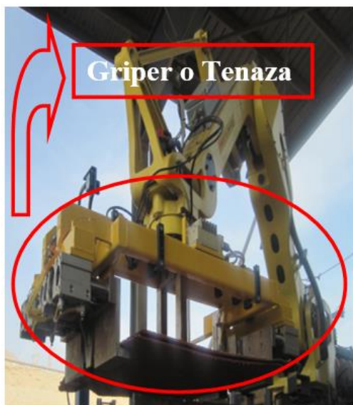
Imagen N°3.- Tenaza del brazo robótico.
