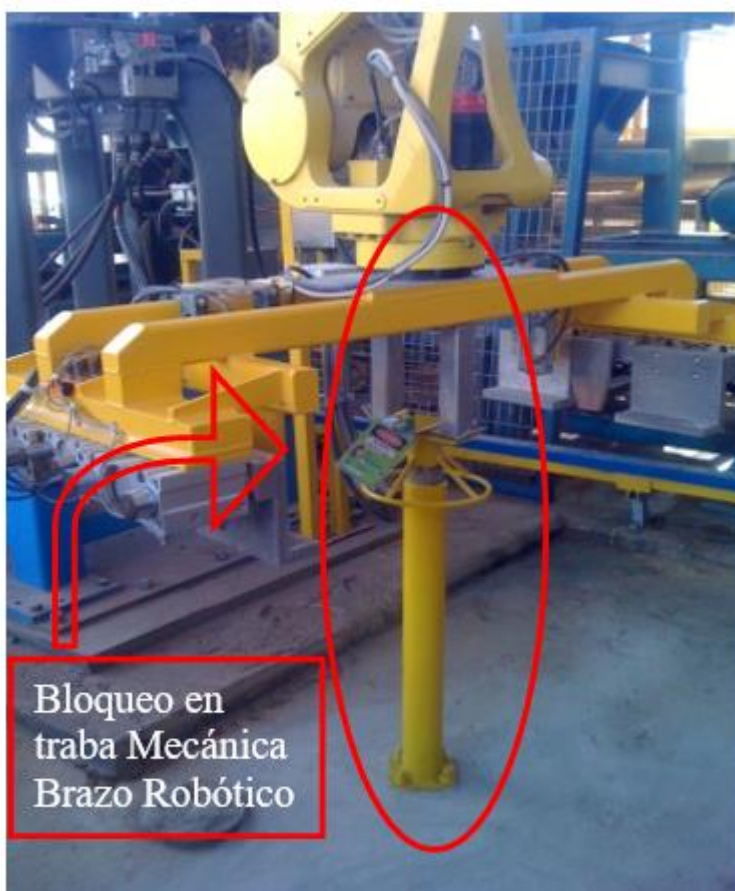
Imagen N° 7.- Traba Mecánica Brazo Robótico
