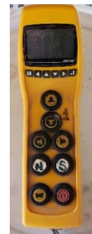
Control Punto grúa 1 Tn.
