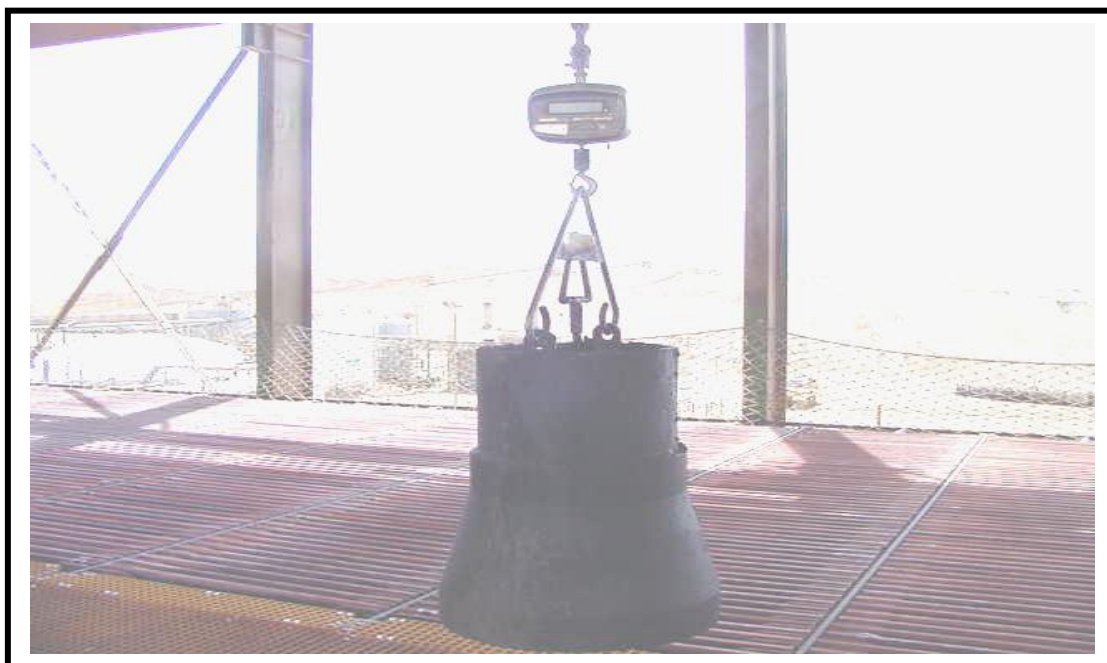
Operación: Pesar los barras anódicas mediante el capacho
