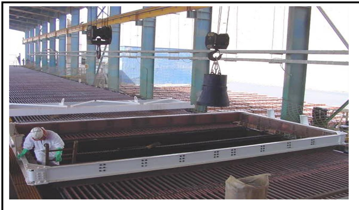
Operación: Retirar el capacho con el contenido de barras anódicas de la celda
