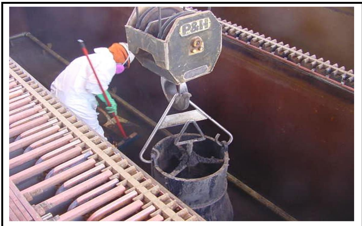
Operación: Limpiar la celda utilizando el capacho para los barras anódicos
