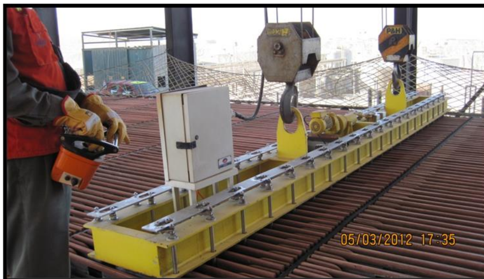
Foto 3: Operador retirando lingada desde celda que está en cosecha
