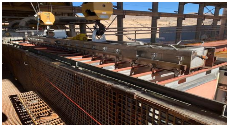
Figura 4: Operador ingresando lingada desde celda a correa de la maquina despegadora.
