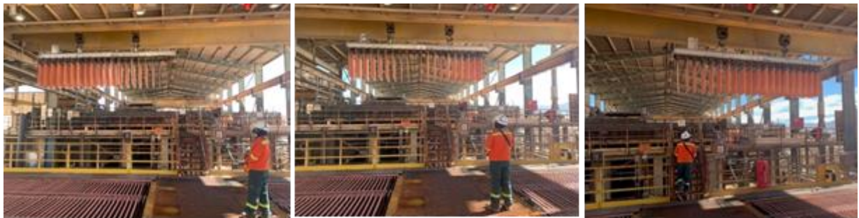
Figura 7: Secuencia de transición en lado “B” para trasladar lingada a cadena de carga MDC.
