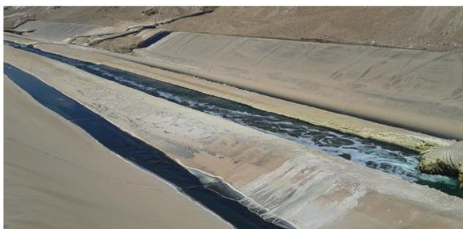
Imagen N°1: Canaletas las cuales llevan la solución de PLS a las piscinas.
