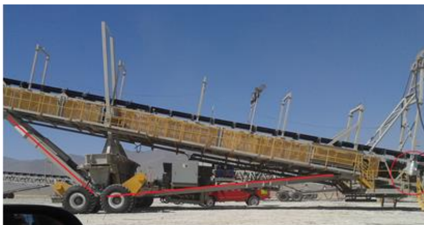
Imagen N°2: Piernas de estructuras el cual permiten manipular la altura de forma segura de las correas.
