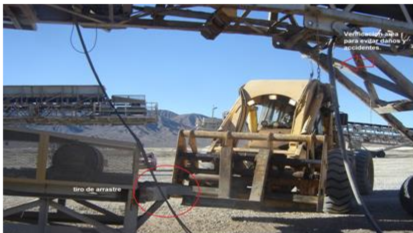
Imagen N°1: Indicación del tiro de arrastre, cual permite el transportar y mover las portables.
