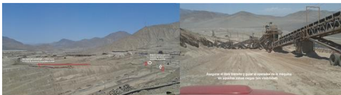
Imagen N°6: Traslado libre de correas transportadoras en rampa en conjunto a un operador guía.
