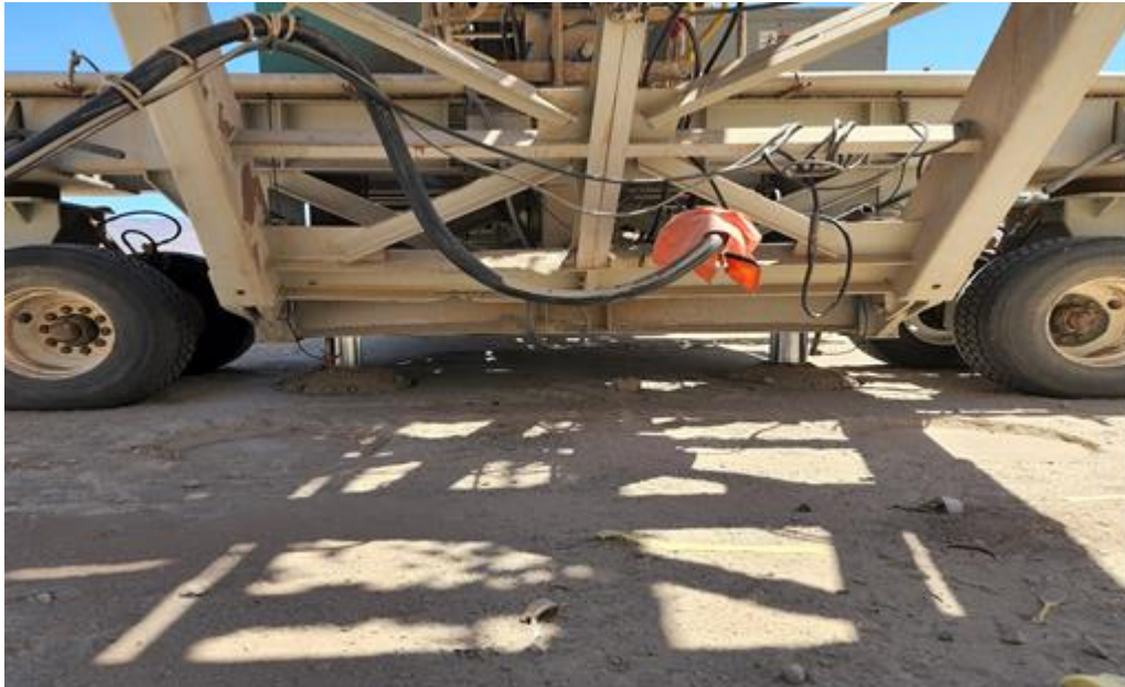
Imagen N°9 Gatas hidráulicas apoyadas en piso.
